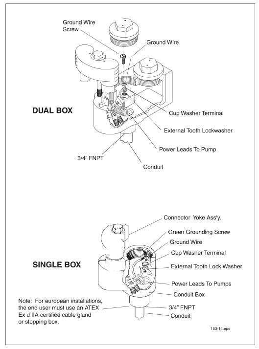
Figure 14. Conduit Box Wiring
